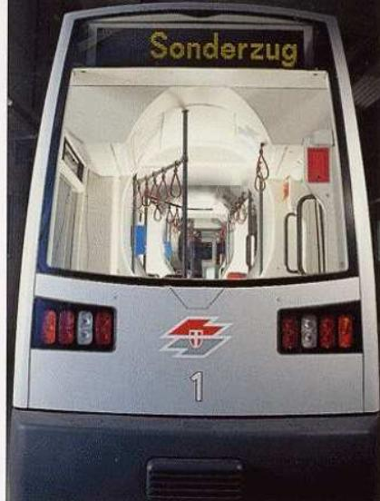
Der durchgehend ebene Wagenboden der Niederflurstraßenbahn SGP ULF unterscheidet das Fahrzeug von allen anderen Niederflurlösungen. Die Gestaltung des Innenraums stammt wie das Design des gesamten Fahrzeugs von Porsche Design.
