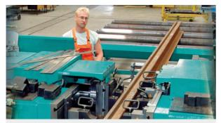
Jede Schiene muss auf den jeweiligen Radius millimetergenau gebogen werden.
