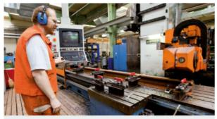
Die Blockherze und die Flachrille der Schienen werden aus dem Rohmaterial mittels CAM/CNC-Fräsen herausgearbeitet.
