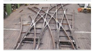
So sieht die fertige Anlage bei der Endkontrolle aus – danach wird sie in transportfähige Einzelteile zerlegt.
