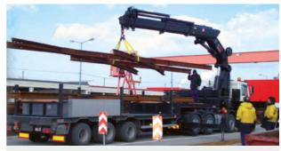
Die Anlagenteile werden für den Transport auf Sattelzüge verladen – wenn notwendig als Sondertransport mit einer Breite bis zu 6 m.
